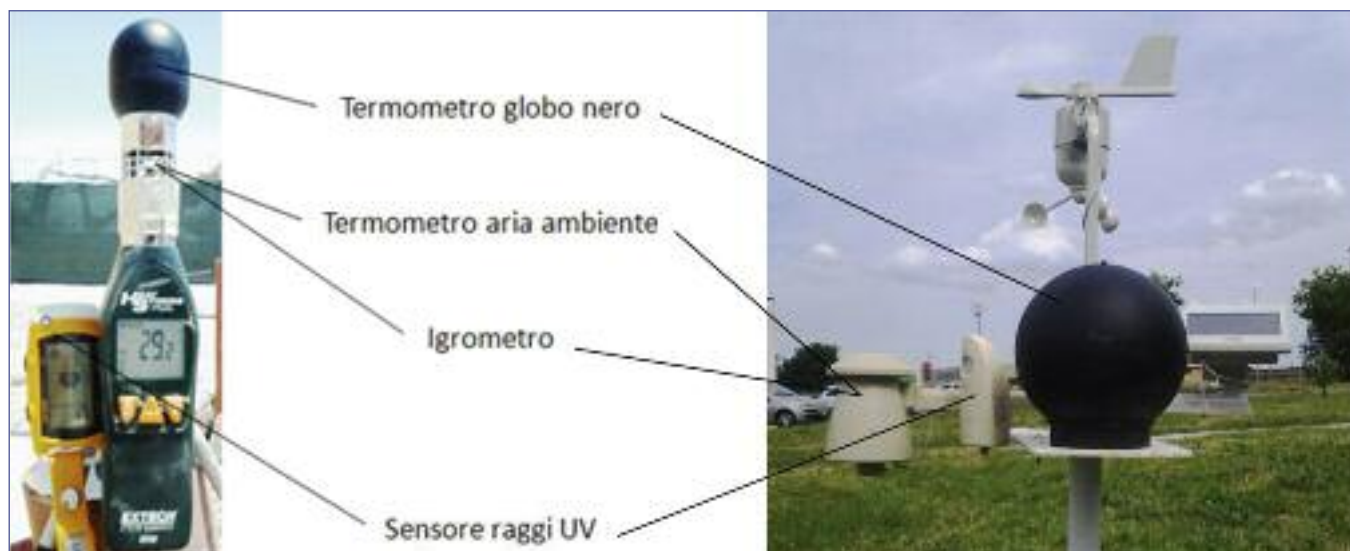
Fig. 3 - Strumentazioni utilizzate in Sarissa (a sinistra) e in Unified Protector (a destra) per la rilevazione del WBGT e UV Index.
