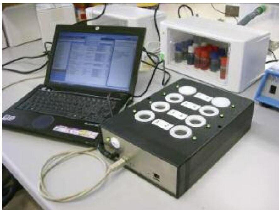
Fig. 3 - MSB multitreader, sistema per l'analisi degli alimenti in ambito campale realizzato in collaborazione con l'Università di Roma "Tor Vergata".
