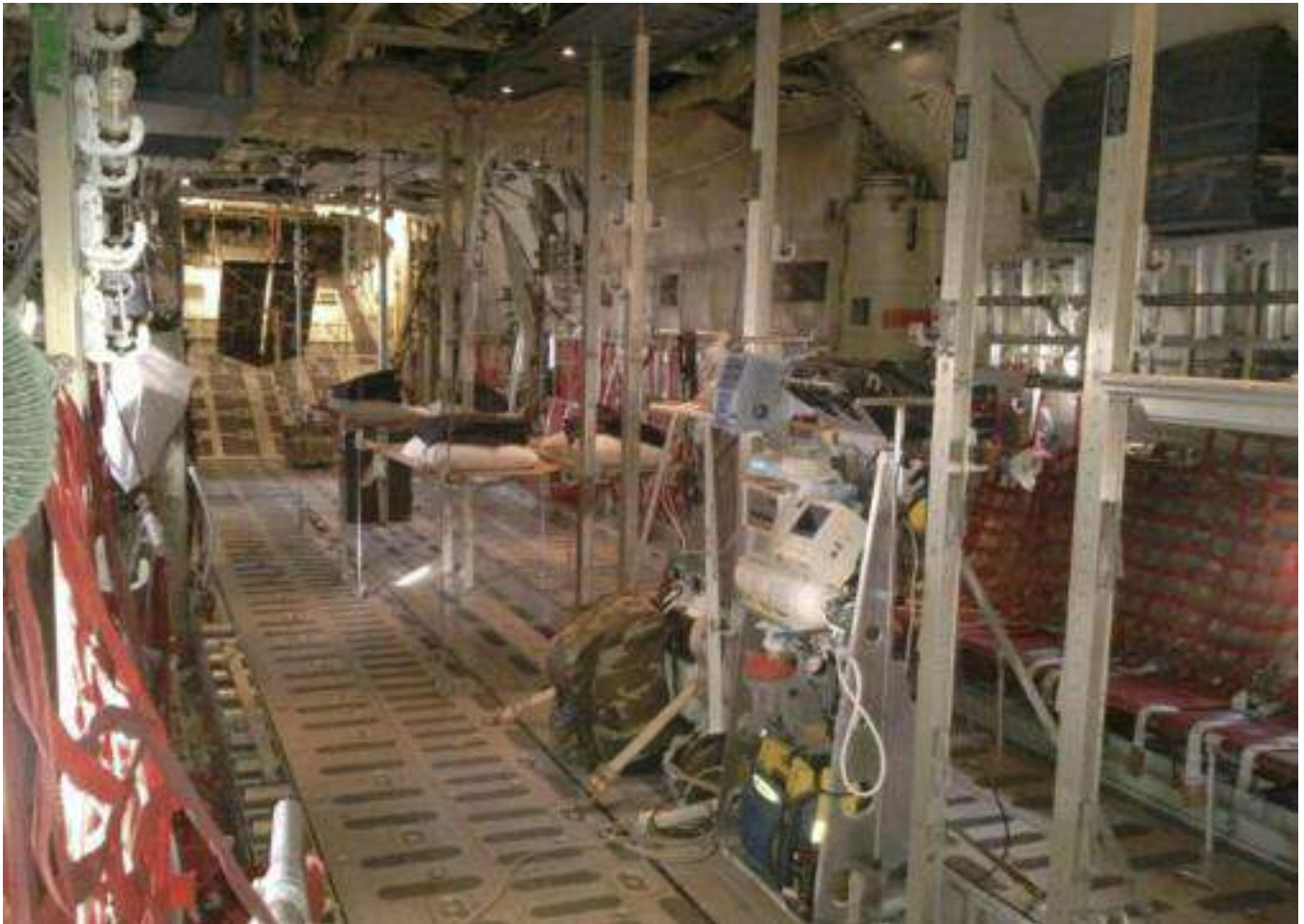
Fig. 3 - Allestimento sanitario standard Lockheed C.130 J. L'aereo può essere configurato sia in modo totalmente sanitario che in quello misto (feriti/passeggeri e feriti/materiale da carico).
