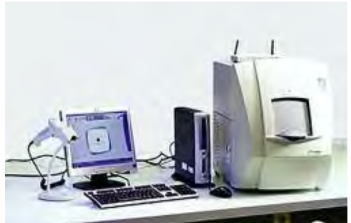
Figg. 9, 10 - Sistema per la conta degli indicatori di qualità microbiologica.
