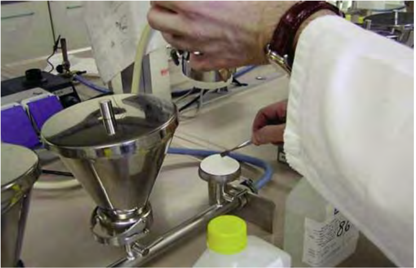
Fig. 8 - Metodo di filtrazione su membrana.
