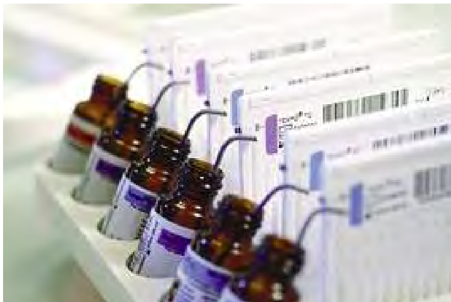
Fig. 11 – Flacone con terreno di coltura specifico liofilizzato e card associata
