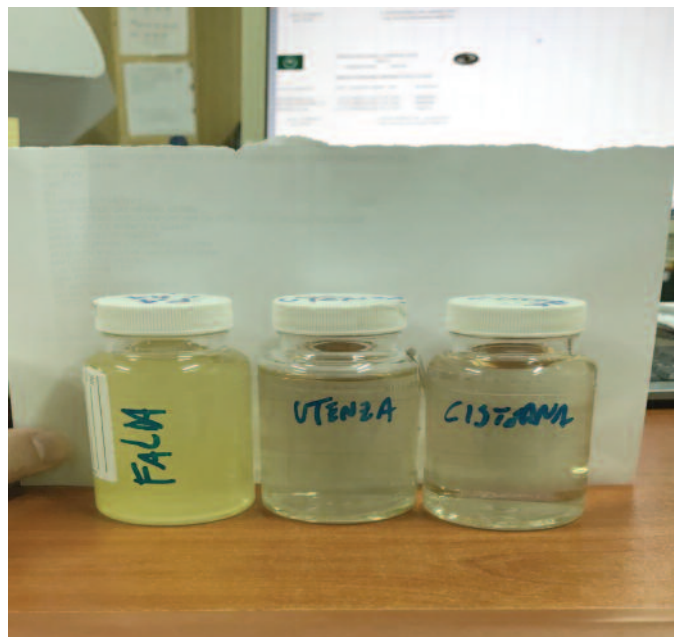
Fig. 7 - campioni di acqua analizzati dal laboratorio analisi del ROLE 2E di Herat dopo il trattamento con cloro.
