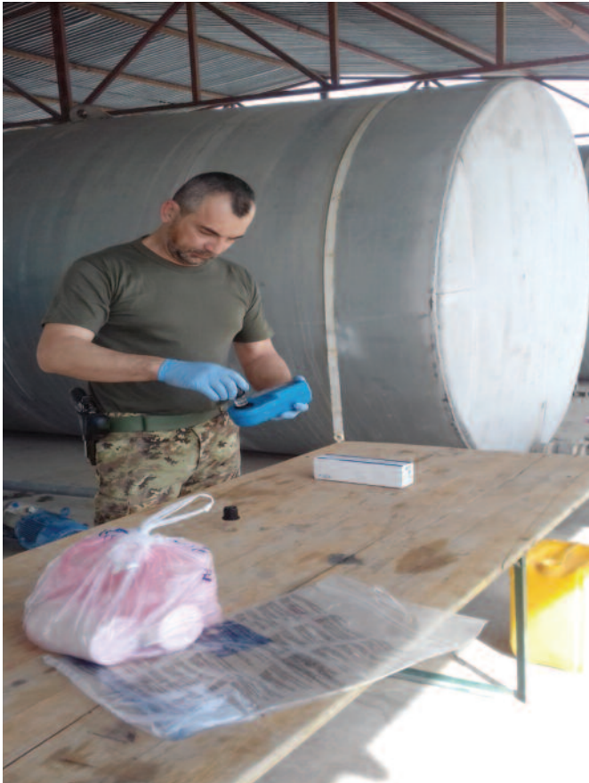
Fig. 5 - Utilizzo dell'analizzatore di cloro libero residuo.
