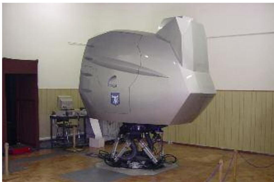
*Fig. 3* - Simulatore di disorientamento spaziale.
