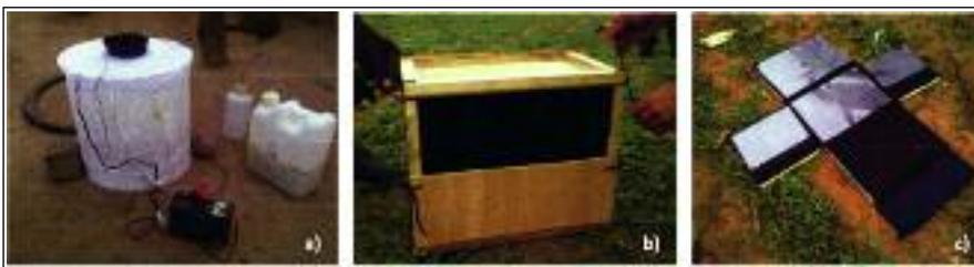
**Fig. 1** - a) BG-Sentinel trap, innescata con BG-lure (non visibile) e CO<sub>2</sub> ottenuta attraverso fermentazione da lievito (contenitore a destra); b) Sticky Resting Box chiusa, innescata con una fonte di umidità (non visibile) e pronta per essere impiegata sul campo e c) Sticky Resting Box aperta, dove si notano le superfici adesive interne che fungono da sistemi di cattura.
