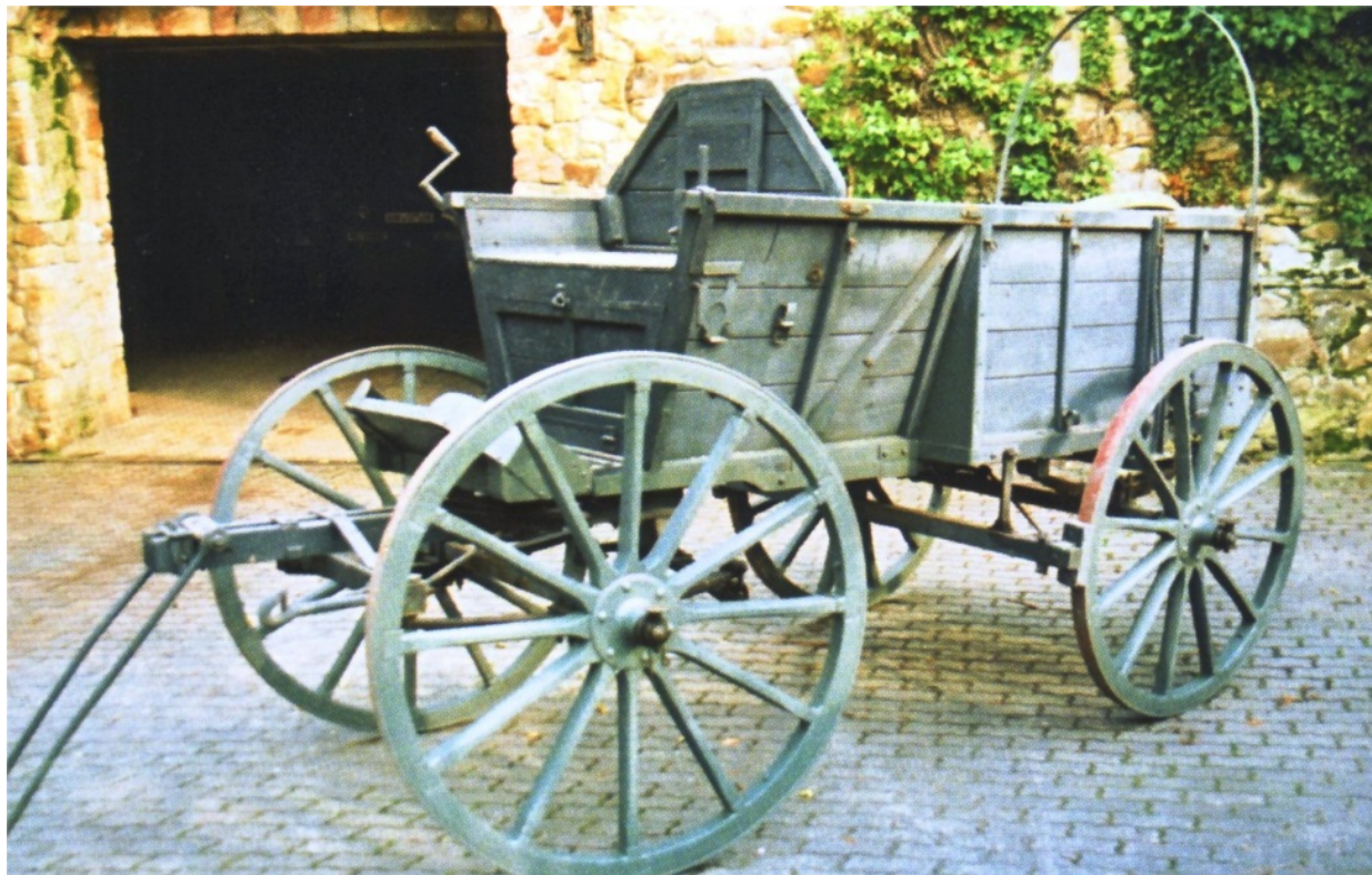
Figura 7 Hf. 1 ammortizzata. Si notino le sospensioni a balestra e la molla trasversale anteriore. (Bespannte Fahrzeuge des deutschen Heeres bis 1945)
