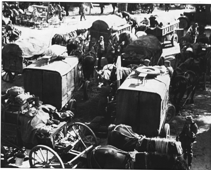
Figura 12 Convoglio di Sanità in sosta. Le due Sf. 1 portano la ruota di scorta fissata sul tetto e si può apprezzare il sistema di chiusura, posteriore e laterale, a mezzo di teli. (Bespannte Fahrzeuge des deutschen Heeres bis 1945)
