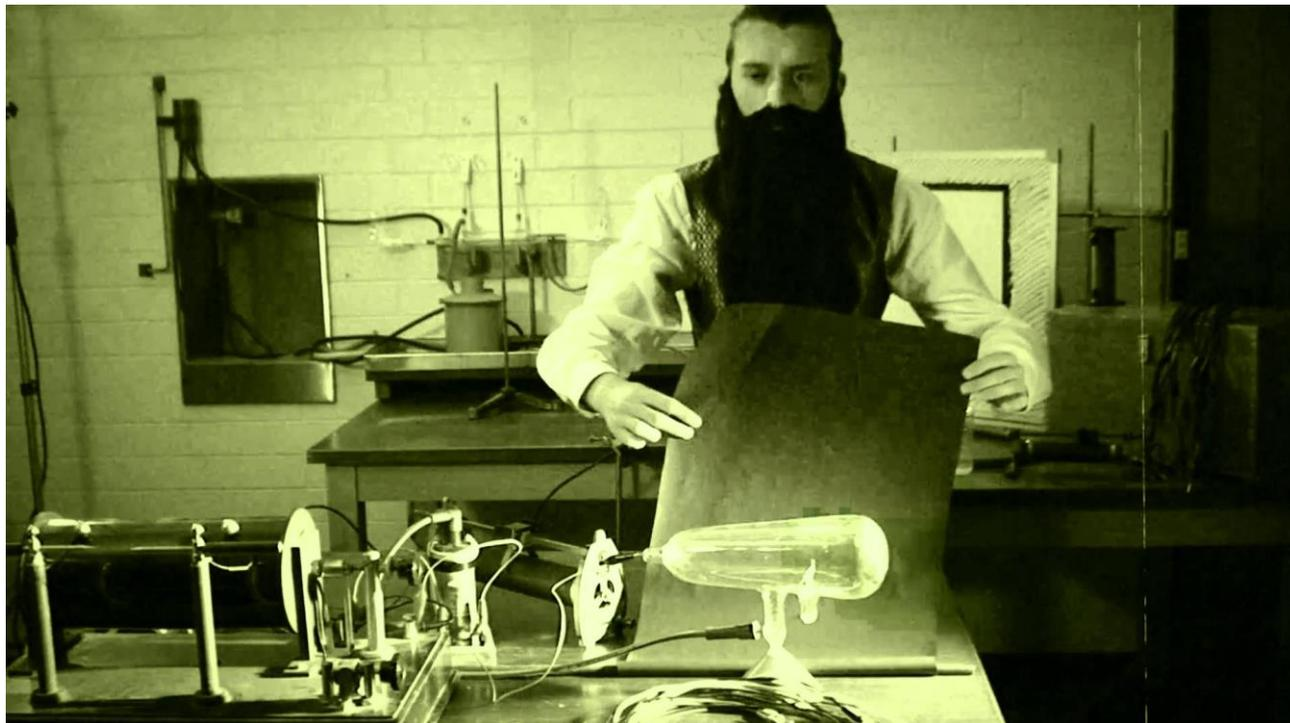
**Figura 2.** Un tubo (o ampolla) di Hittorf del tipo utilizzato da Röntgen per le sue ricerche iniziali [open source].
