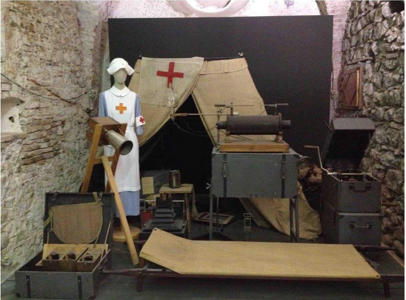
**Figura 11.** Il tubo *focus*: tubo di Crookes modificato con l'inserimento di un anticatodo per concentrare e indirizzare il fascio di raggi X, entrato in uso nelle apparecchiature radiologiche militari durante la guerra 1915-18 e adottato, in particolare, nell'ambulanza radiologica modello Perussia [open source].
